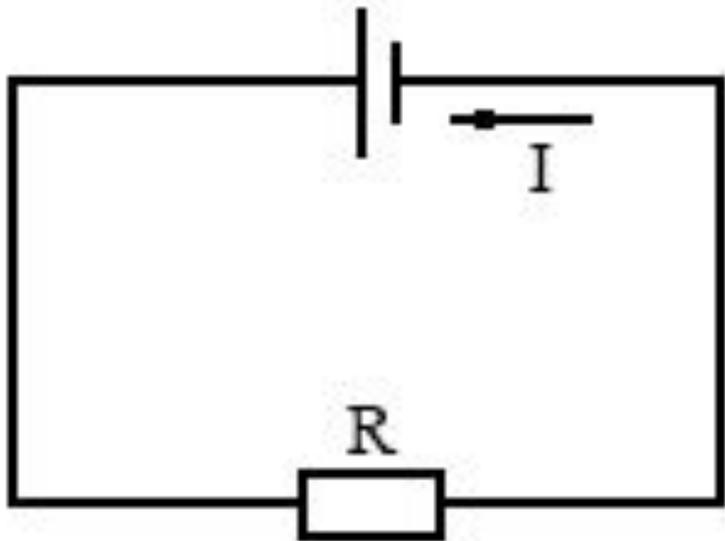
Рассмотрим простейшую полную (замкнутую) цепь, состоящую из источника тока и резистора сопротивлением  $R$ .
