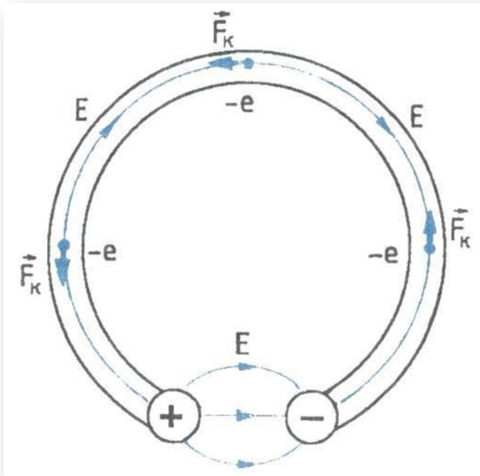
Соединим проводником два металлических шарика, несущих заряды противоположных знаков. Под влиянием электрического поля этих зарядов в проводнике возникает электрический ток.
