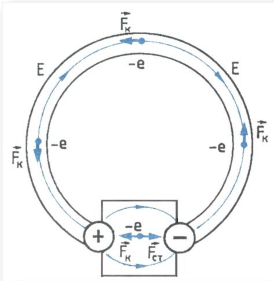
При замыкании цепи создаётся электрическое поле во всех проводниках цепи.
