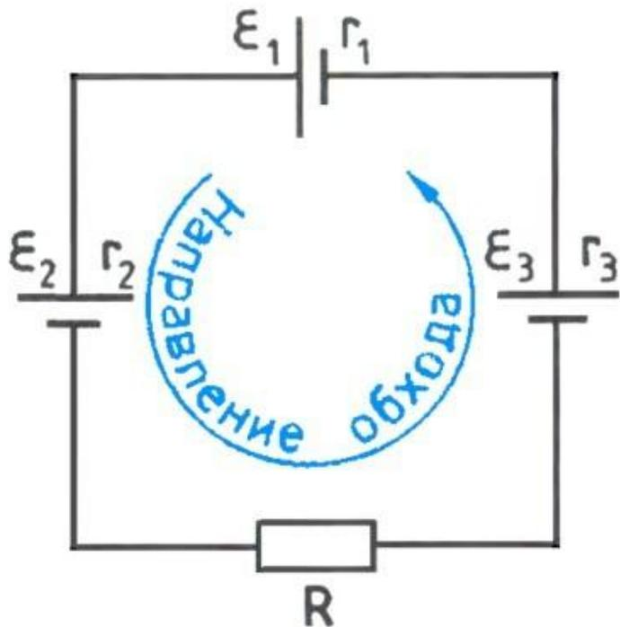
Если цепь содержит несколько последовательно соединённых элементов с ЭДС  $\mathcal{E}_1, \mathcal{E}_2, \mathcal{E}_3$  и т.д., то полная ЭДС цепи равна алгебраической сумме ЭДС отдельных элементов.
