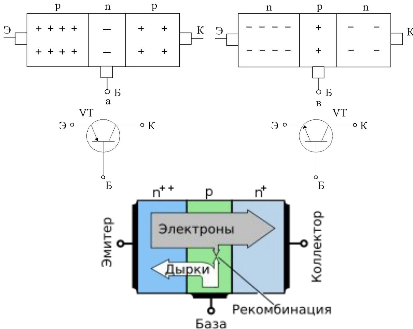
Структура биполярного n-p-n транзистора. Ток через базу управляет током «коллектор-эмиттер».
