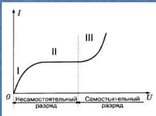
Ионизация осуществляется **электронным ударом**. Возможна при условии  $\frac{mv^2}{2} \geq A_i$
