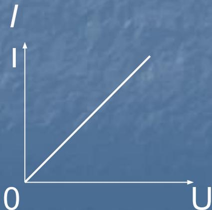
Зависимость силы тока от напряжения (ВАХ) в проводнике определяется законом Ома
