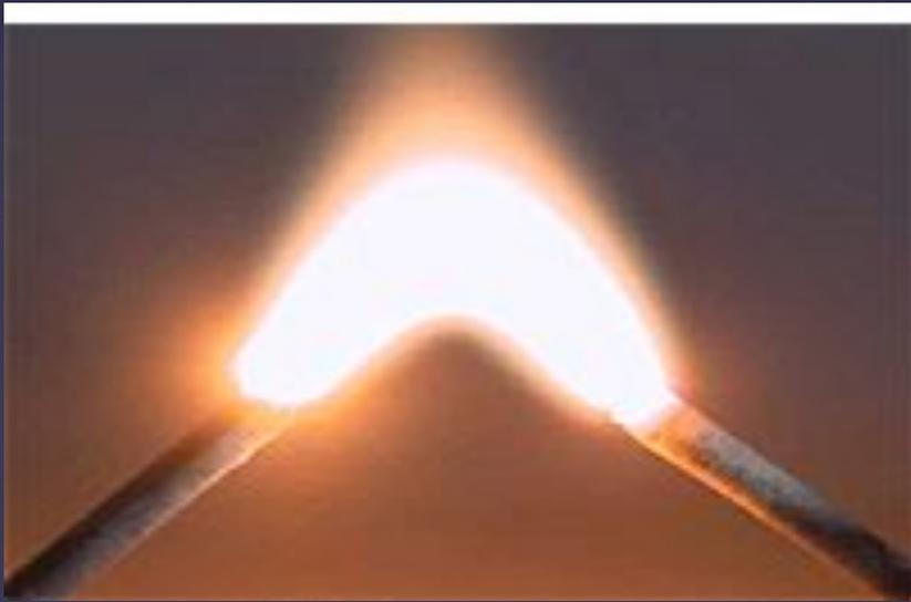
Дуговой разряд применяется для сварки металлических деталей, для выплавки сталей и сплавов. При этом лицо сварщика или рабочего сталелитейного производства должно быть закрыто толстым тёмным стеклом, чтобы ультрафиолетовое излучение, испускаемое дугой, не повредило глаза и кожу. В мировой промышленности около 90% инструментальной стали выплавляется именно в дуговых электропечах.
