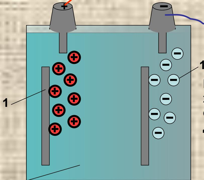
В процессе зарядки в результате химической реакции один электрод становится **положительно** заряженным, а другой – **отрицательно**.
