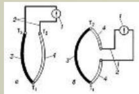
Термопара. Если нагревать место спайки двух различных металлов, то создается электрический ток. Применяется в датчиках.
