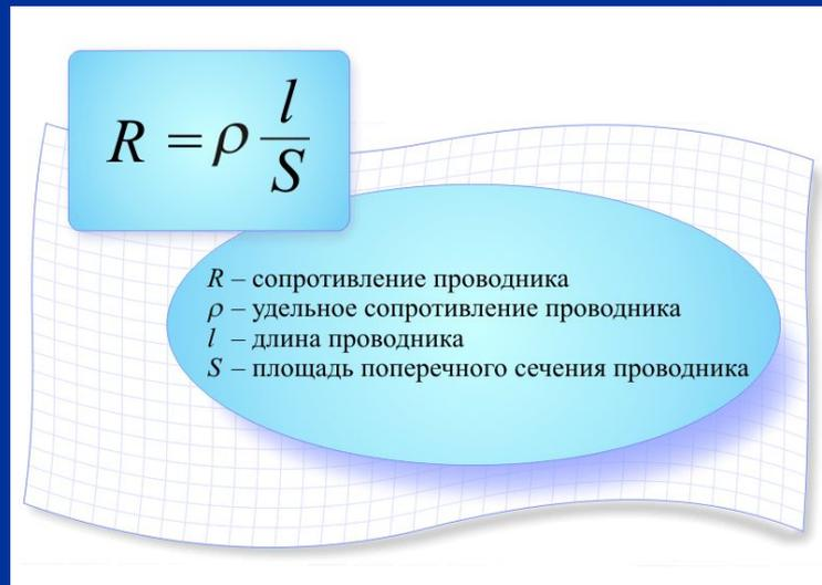
The diagram features a light blue rounded rectangle containing the formula  $R = \rho \frac{l}{S}$ . Below it, a larger light blue oval contains the following definitions:  $R$  – сопротивление проводника,  $\rho$  – удельное сопротивление проводника,  $l$  – длина проводника, and  $S$  – площадь поперечного сечения проводника. The background is a white grid pattern.
