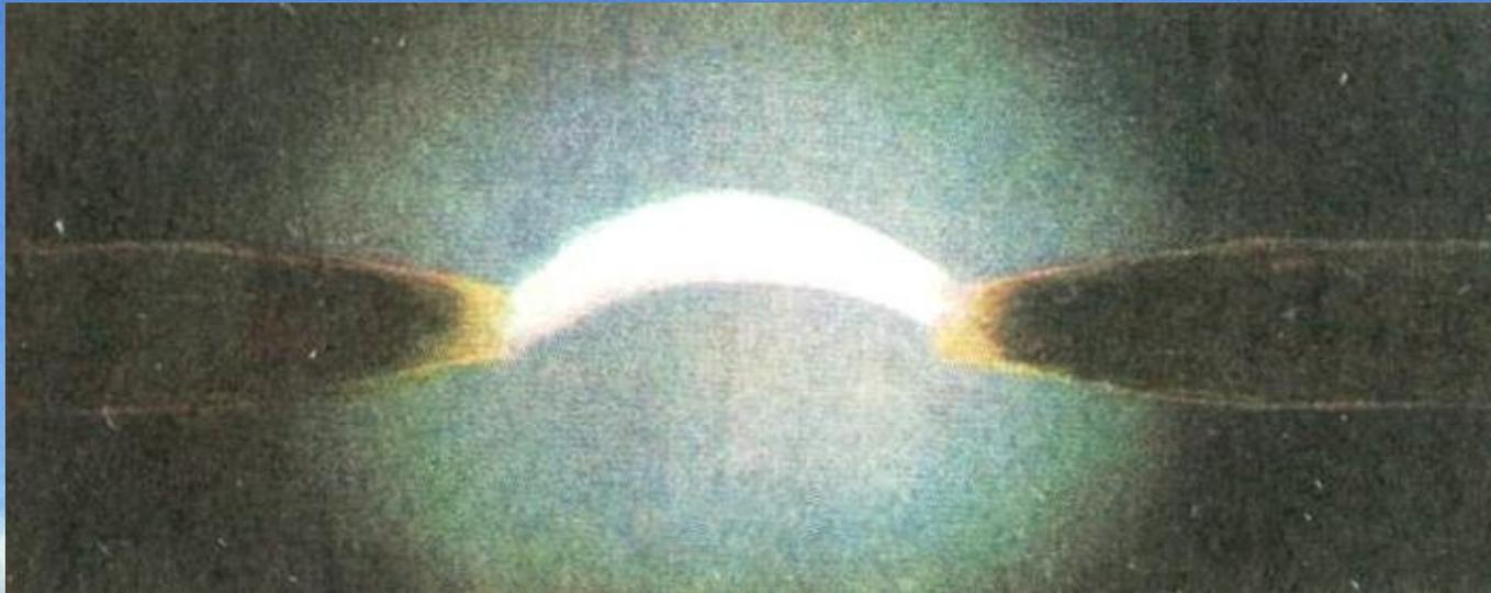
Вольтамперная характеристика дуги носит совершенно своеобразный характер. В дуговом разряде при увеличении тока напряжение на зажимах дуги уменьшается, т.е. дуга имеет падающую вольтамперную характеристику.
