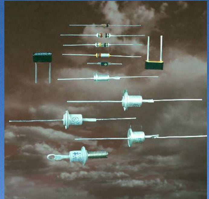
Транзисторы, как и диоды, чувствительны к температуре и перегрузке и проникающим излучением. Транзисторы в отличие от радиоламп сгорают от неправильного подключения.
