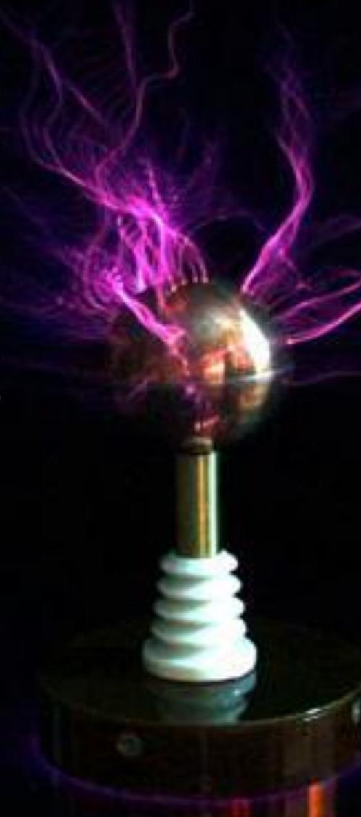
разряде происходят только в ограниченной области вблизи электродов (коронирующий слой). Коронный разряд может образовываться между проводниками высоковольтных линий электропередач, что приводит к значительным потерям энергии.
