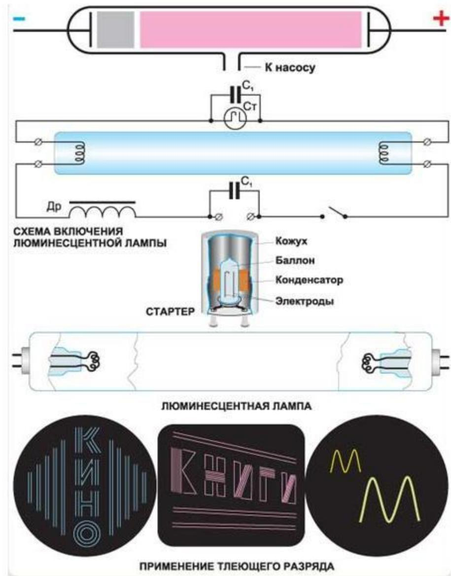
Обычно этот заряд возникает при давлениях в газе значительно ниже атмосферного: 1–10 Па. Проведем опыт. Из стеклянной трубки 2 с электродами, подключенными к высоковольтному источнику тока 1, насосом 3 будем откачивать воздух.
