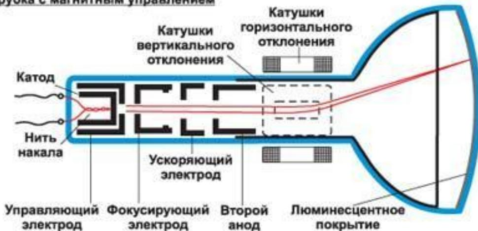
ЭЛЕКТРОННО-ЛУЧЕВАЯ ТРУБКА - устаревшее название ряда электронно-лучевых приборов для преобразования электрических сигналов, например, в видимые изображения (осциллографические, индикаторные электронно-лучевые трубки, кинескопы и др.), оптических изображений в электрические сигналы (телевизионные передающие трубки).
