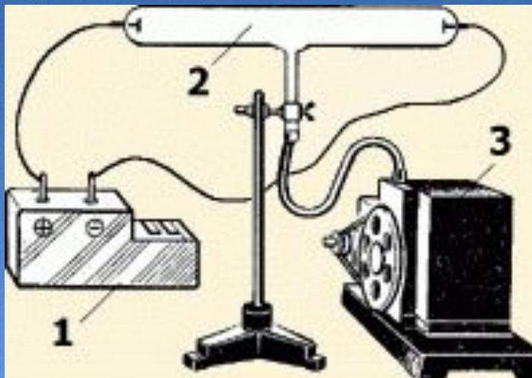
Через некоторое время воздух, оставшийся в трубке, начнет испускать неяркий красно-малиновый свет. Используя вместо воздуха другие разреженные газы, можно наблюдать свечения и других оттенков. Разреженные водород и гелий, например, испускают сине-зеленый свет, а газ неон – красно-оранжевый. Трубки с этими газами, изогнутые в виде букв и других фигур, используют для изготовления светящихся надписей на магазинах, кинотеатрах и т. д.
