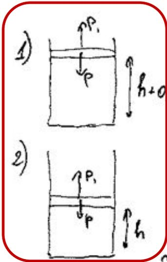
Т.к. в начале и в конце поршень неподвижен, то давление газа равно атмосферному давлению, т.е.  $p = p_1 = 10^5$  Па. Кол-во теплоты переданное к газу вычисляется по формуле  $Q = \Delta U + A$ , где  $\Delta U$  - изменение внутренней энергии,  $A$  - работа газа, так как процесс изобарный, то
