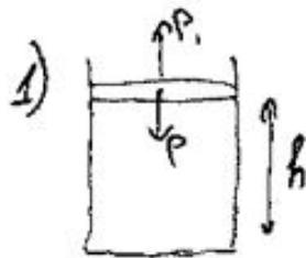
Т.к. в начале и в конце поршень неподвижен, то давление газа равно атмосферному давлению, т.е.  $p = p_1 = 10^5$  Па - во столько же теплоты переданное к газу вычисляется по формуле  $Q = \Delta U + A$ , (первое начало термодинамики)
