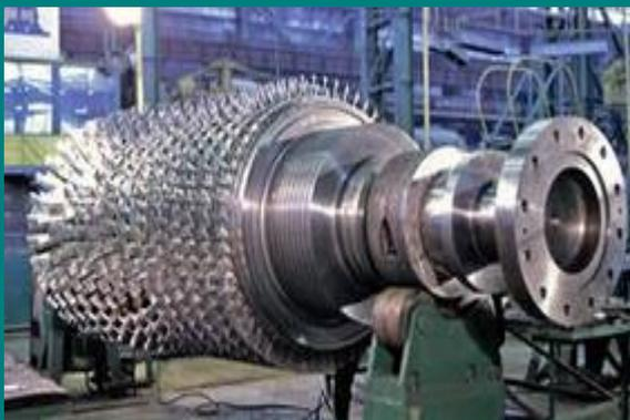
Ротор газовой турбины
