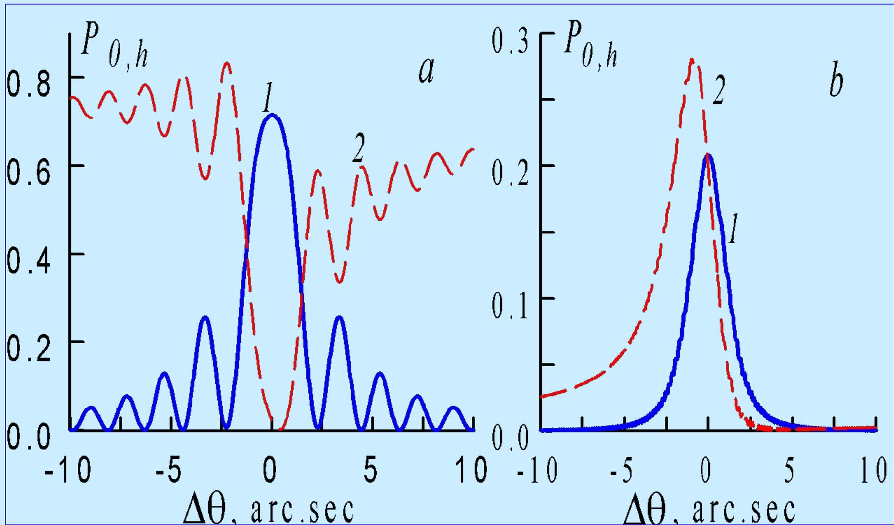
Кривые дифракционного отражения (1) и прохождения (2) в случае Лауэ для кристаллов с толщиной  $l = 23 \mu\text{m}$  (a, **тонкий кристалл**) и  $l = 300 \mu\text{m}$  (b, **толстый кристалл, эффект Бормана**).
