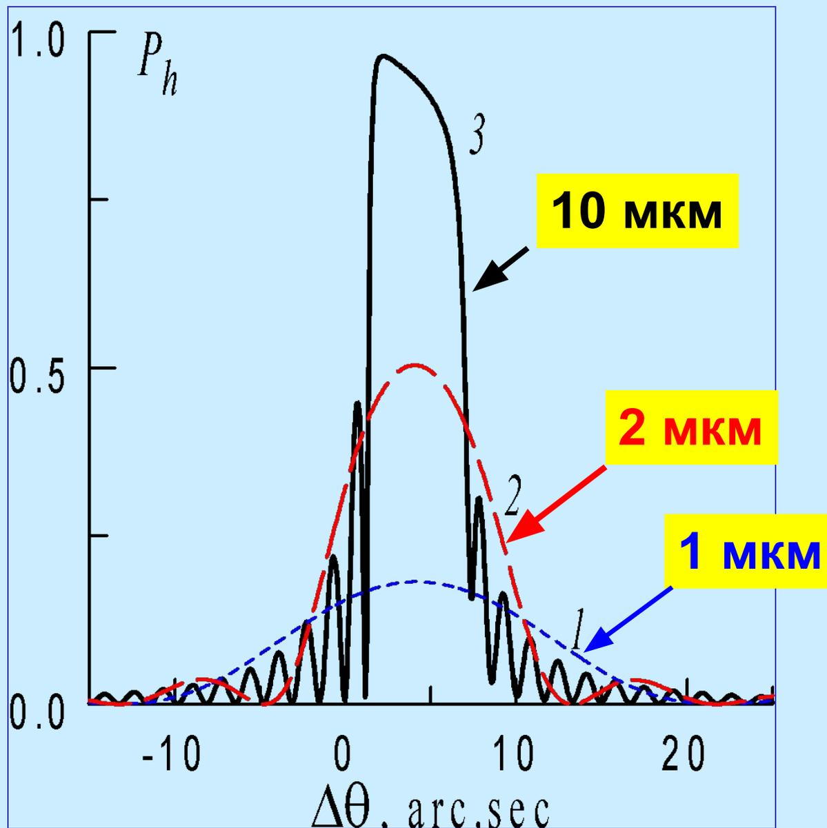
КДО  $\text{CuK}_\alpha$ -излучения от кристалла кремния с толщиной  $l = 1 \text{ }\mu\text{m}$  (1),  $2 \text{ }\mu\text{m}$  (2) и  $10 \text{ }\mu\text{m}$  (3); **симметричное отражение (220)**.
