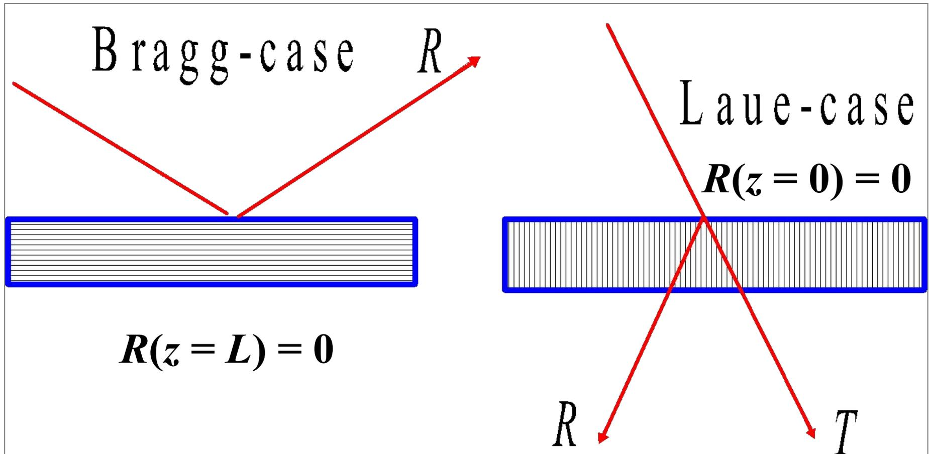
**Две схемы дифракции:** геометрия **Брэгга** (“на отражение”) и геометрия **Лауэ** (“на прохождение”).
