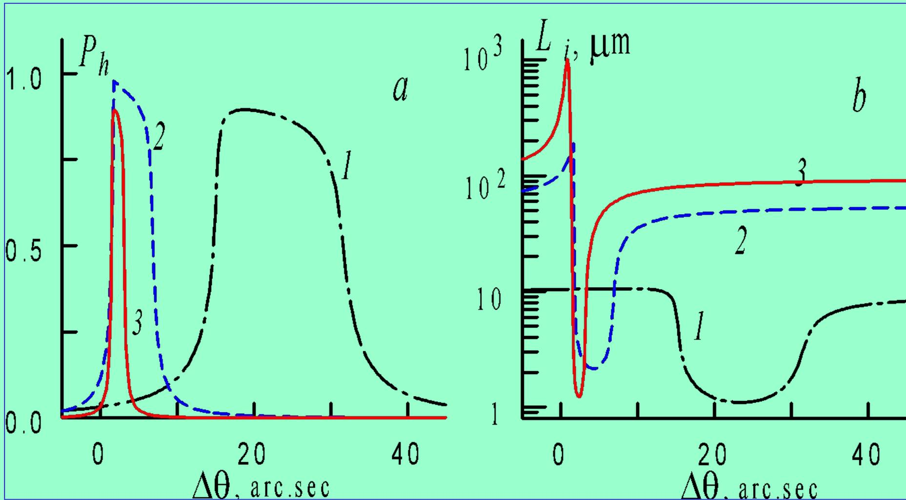
Кривые дифракционного отражения (220)  $\text{CuK}_\alpha$ -излучения от кристалла кремния (a) и угловые зависимости глубины проникновения РЛ в кристалл (b). Коэффициент асимметрии отражения  $b$ : кривые 1 - 0.1, 2 - 1, 3 - 10.
