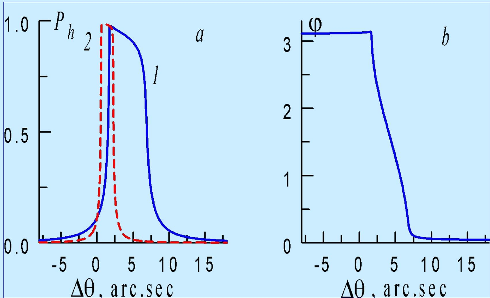
a) - кривые дифракционного отражения (220) излучения  $\text{CuK}_{\alpha}$  (1) и  $\text{AgK}_{\alpha}$  (2) от толстого кристалла кремния,  $b = 1$ , b) - зависимость фазы отражения от угловой отстройки.
