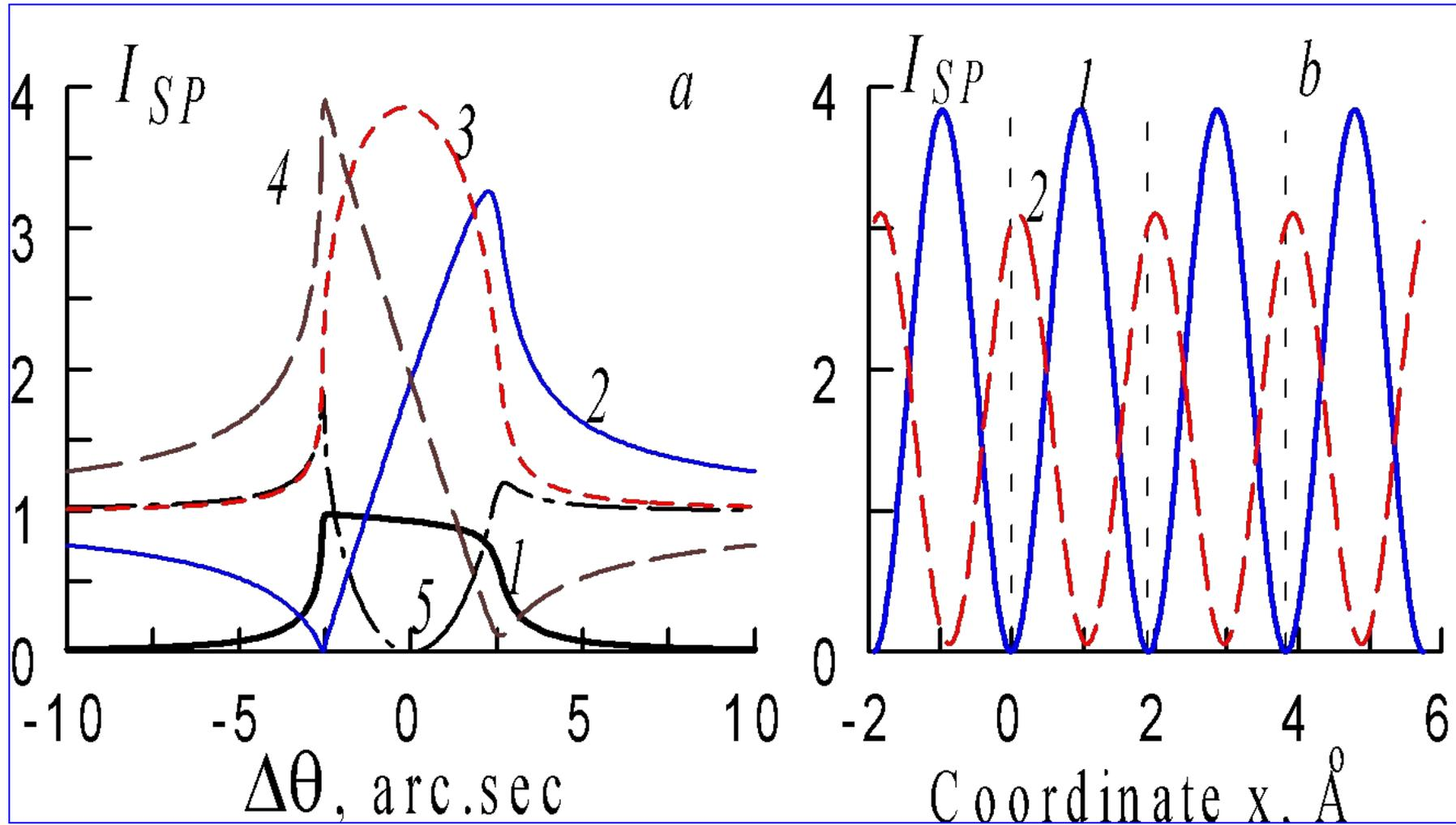
*a* - КДО (1), угловая зависимость интенсивности полного поля в кристалле при  $z = 0$  (2),  $z = d/4$  (3),  $z = d/2$  (4),  $z = 3d/4$  (5); *b* – пространственное распределение стоячей волны при угловых отстройках  $\Delta\theta = -\Delta\theta_B$  (1) и  $\Delta\theta = \Delta\theta_B$  (2). Вертикальные линии показывают положение атомных плоскостей.  $\text{CuK}_\alpha$ -излучение, Si(220),  $b = 1$ .
