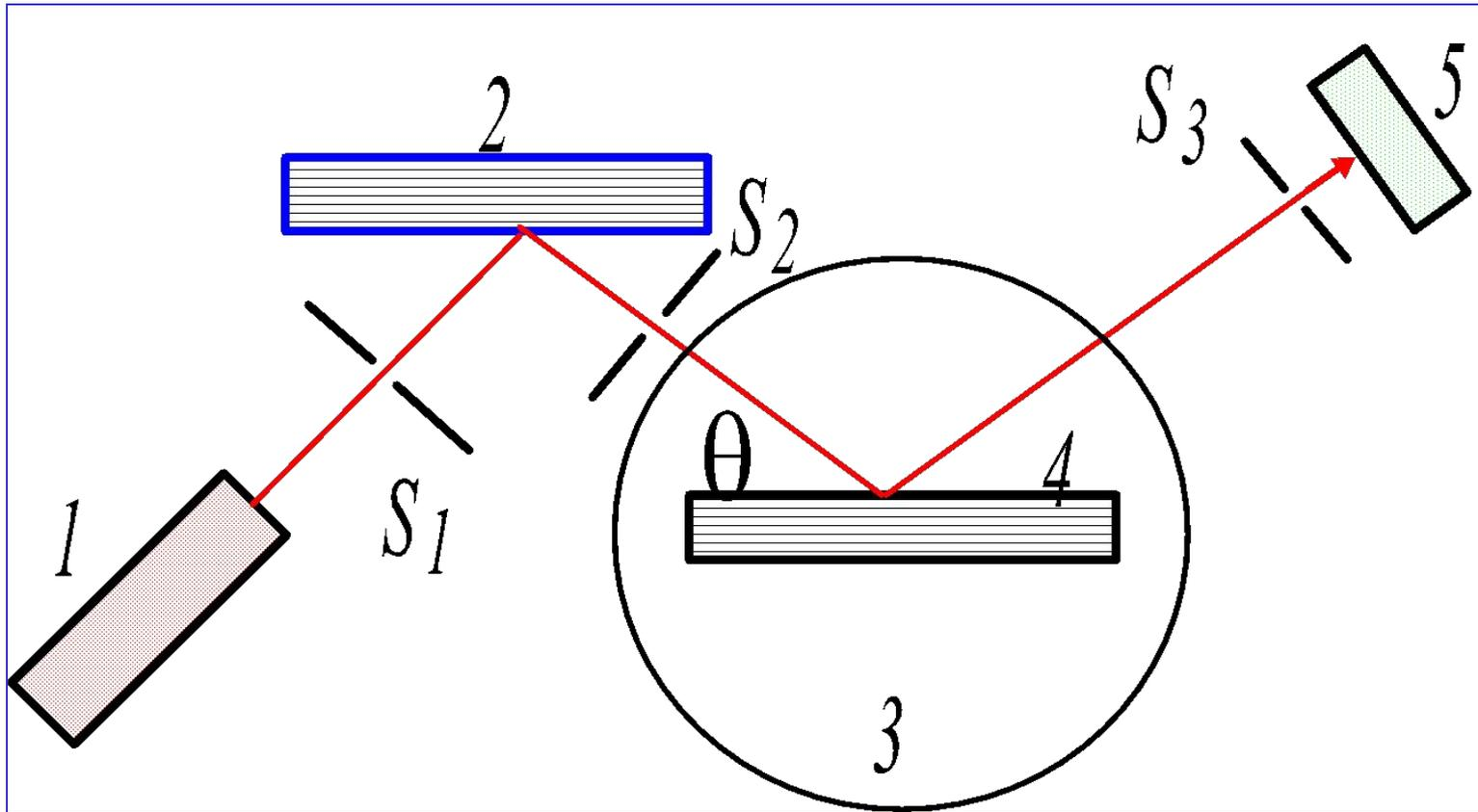
Схема эксперимента по регистрации кривой дифракционного отражения (КДО). 1 - рентгеновская трубка, СИ, РЛСЭ; 2 - кристалл-монокроматор, 3 - гониометр, 4 – исследуемый образец, 5 - детектор,  $S_{1-3}$  - щели.
