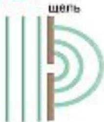
ОПТИЧЕСКАЯ СХЕМА ДИФРАКЦИИ
