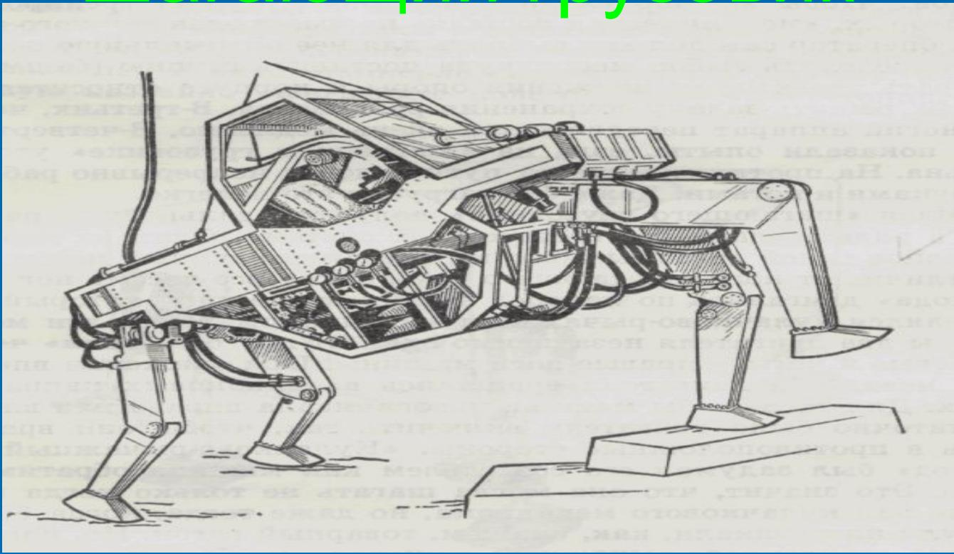
Этот гигант общей высотой 3,05 м имеет массу около полутора тонн. Он снабжен 90-сильным автомобильным мотором, от которого работает гидронасос, питающий гидродвигатели механизмов четырех длинных (более двух метров) «ног». Каждая нога – это трехзвеный рычаг. Движение каждого из сочленений осуществляется отдельным приводом. А управляет всеми этими движениями человек, сидящий в кабине, расположенной в центральной части машины.
