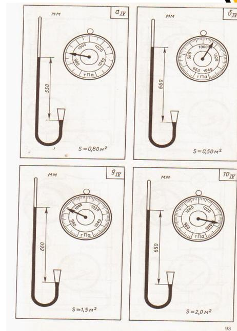
На рисунках карточек IV серии справа изображены барометры-анероиды (рис. 4), которые показывают атмосферное давление в гектопаскалях у подошвы горы. Слева изображен ртутный сифонный барометр, измеряющий атмосферное давление в одно время с анероидом, но уже на горе. Высота его ртутного столба отмечена размерной линией и дана в миллиметрах.
