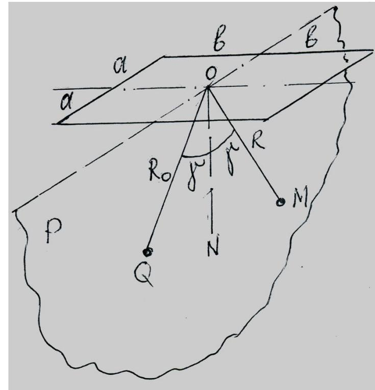
При построении геометрических отражений от плоскости удобен метод мнимых источников (МИ).
