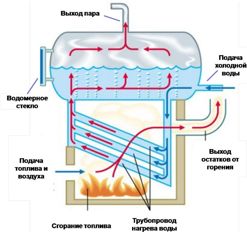
Схема работы парового котла
