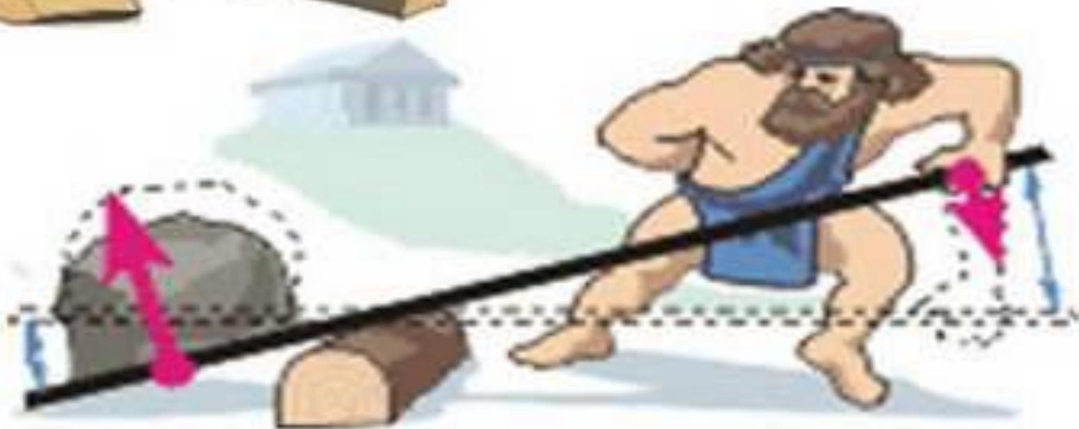
Приспособления, служащие для преобразования силы, называют механизмами.
