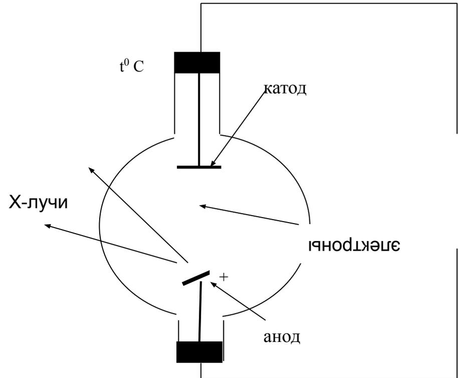
Рис.1 Устройство рентгеновской трубки
