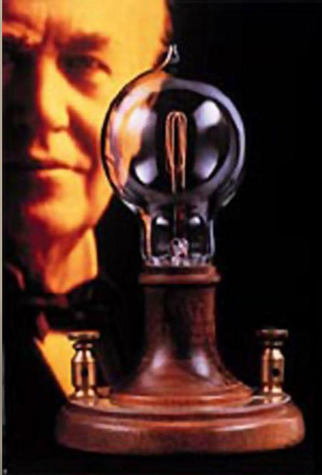
Важную доработку в созданной Яблочковым лампе накаливания изобрел знаменитый американец **Томас Эдисон**. Он поместил устройство в вакуумную оболочку, которая защитила контакты с электрической дугой от окисления, поэтому его лампа могла давать свет достаточно длительное время. С его помощью история развития электрического освещения получила новый мощный импульс. 21 октября 1879 года он включил первую лампочку, которая смогла гореть два дня
