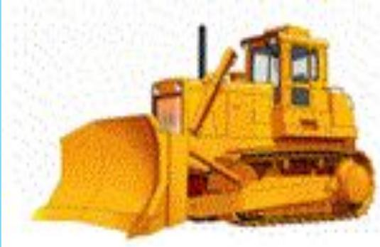
... давление **гусеничного трактора** массой 6,7 тонны на почву составляет **47 000 Па**.
