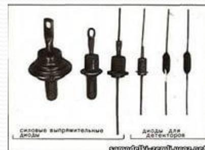
**Главное свойство – односторонняя проводимость. Используется для выпрямления слабых токов в радиоприемниках, телевизорах, и сильных токов в ЭД трамваев, электровозов.**
