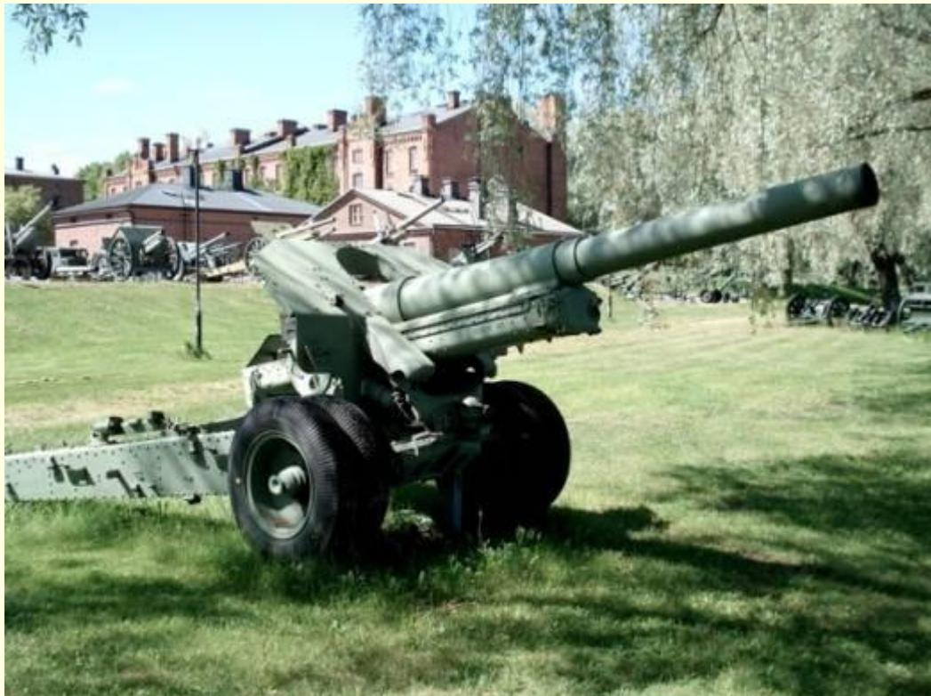
152-мм пушка – мощное и дальнобойное орудие с максимальным углом возвышения. В боекомплект гаубицы входят снаряды раздельного заряжания с осколочным, осколочно-фугасным и бетонобойным снарядами. Начальная скорость снаряда - 508 м/с.
