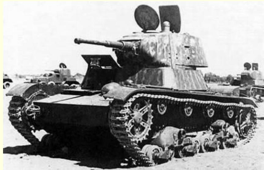
Огнеметный танк ОТ-130. Дальность огнеметания 35-50 метров.
