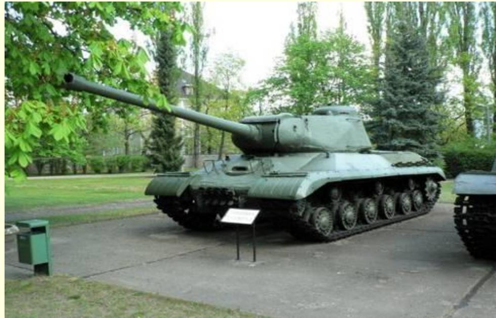
**ИС-2 самым мощным и наиболее тяжелобронированным из советских серийных танков периода войны: толщина брони была 90-120 мм, развиваемая скорость — до 52 км/ч**
