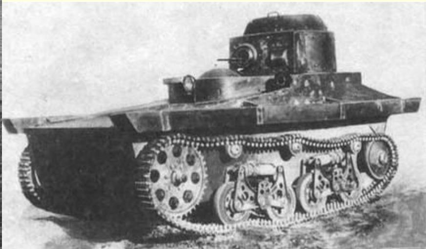
Т-37А - советский малый плавающий танк. Для обеспечения плавучести танк был оснащен дополнительными поплавками, размещенными вдоль бортов корпуса. Развивал скорость на суше до 40 км/ч, а на плаву - до 6 км/ч.
