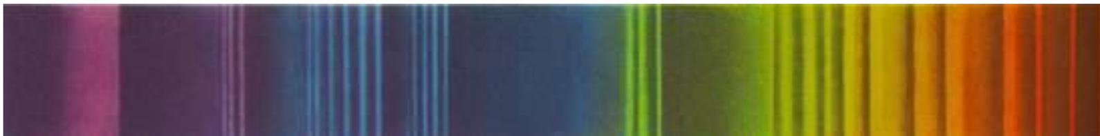
**Спектр испускания паров молекулы йода.**
