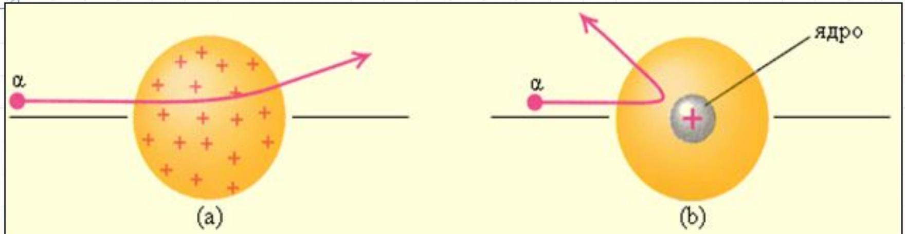
$\alpha$ -частица имеет положительный заряд, поэтому отталкивается от положительного заряда, расположенного где-то внутри атома. При этом чем ближе будет проходить траектория  $\alpha$ -частицы к положительному заряду атома – тем больше сила действующая на нее, тем сильнее изменится ее траектория.
