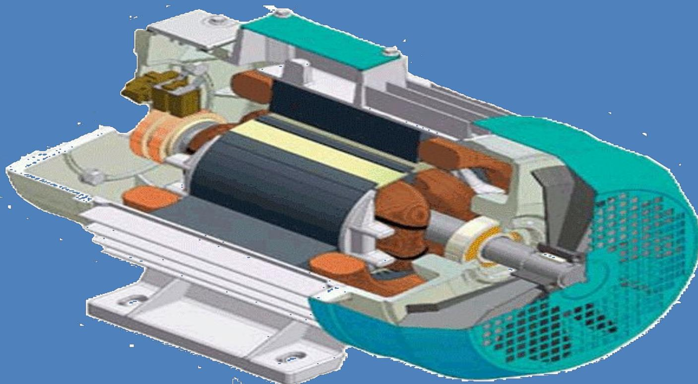
**Электродвигатель постоянного тока (ДПТ) — электрическая машина постоянного тока, преобразующая электрическую энергию постоянного тока в механическую энергию.**
