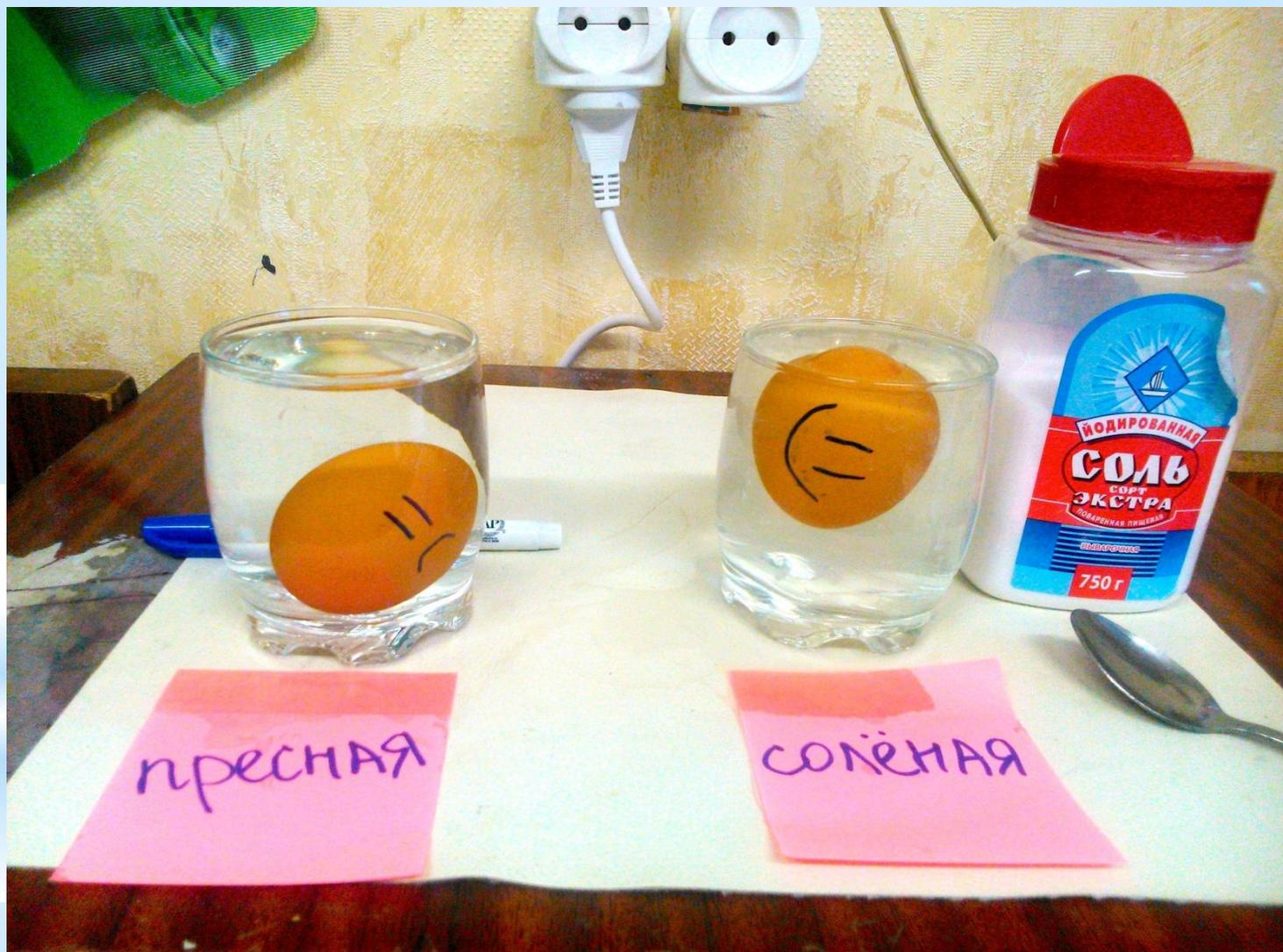
Вывод: глубина погружения зависит от плотности жидкости
