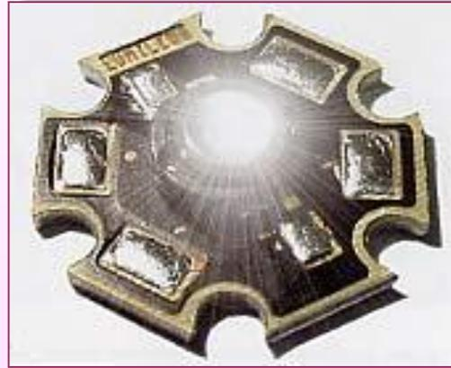
Мощный звездообразный светодиодный модуль (5Вт, 120 лм);
