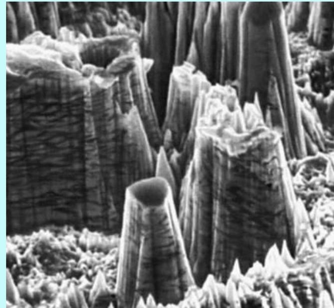
**Изображение предварительно отполированной, а затем подвергнутой ионной бомбардировке поверхности монокристалла меди. Снято в растровом электронном микроскопе. Увеличение - 3000.**
