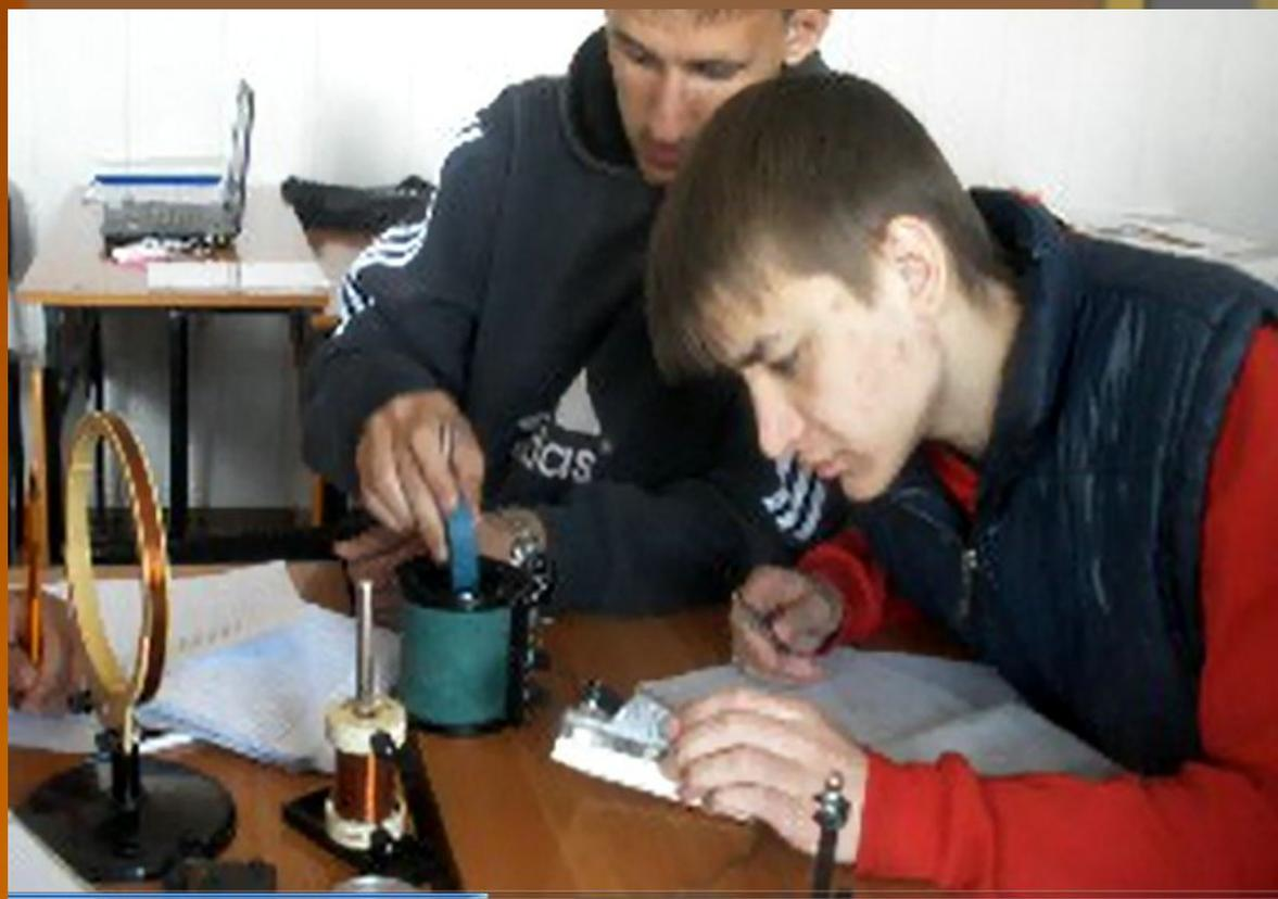
**Гальванометр регистрирует появление тока в замкнутой на него катушке при вставлении в нее магнита.**
