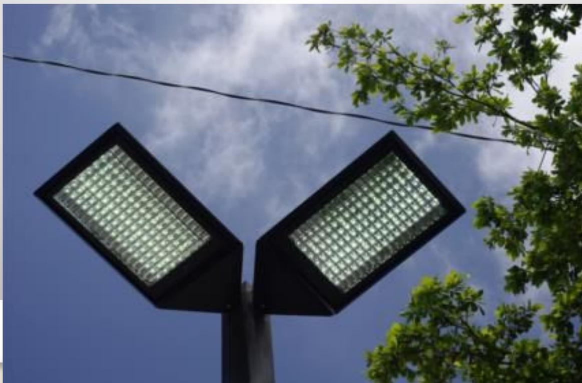
Светодиоды в корпусе лампы напаяют на специальную поверхность – плату, количество светодиодов, установленных в одной лампе, может быть от нескольких штук до нескольких десятков.
