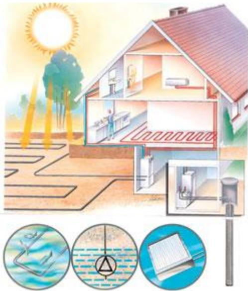
Тепловой насос извлекает накопленную энергию из различных источников - грунта, рек, озер, морей, стоков, вентиляционных выбросов и дымовых газов; земных недр и переносит ее в дом. По прогнозу Мирового Энергетического Комитета (МИРЭК), к 2020 году в передовых странах доля отопления и горячего водоснабжения от тепловых насосов составит не менее 75%. Изобрел еще
