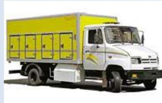
Изотермический автофургон, оборудованный турбохолодильной установкой на ДМЭ
