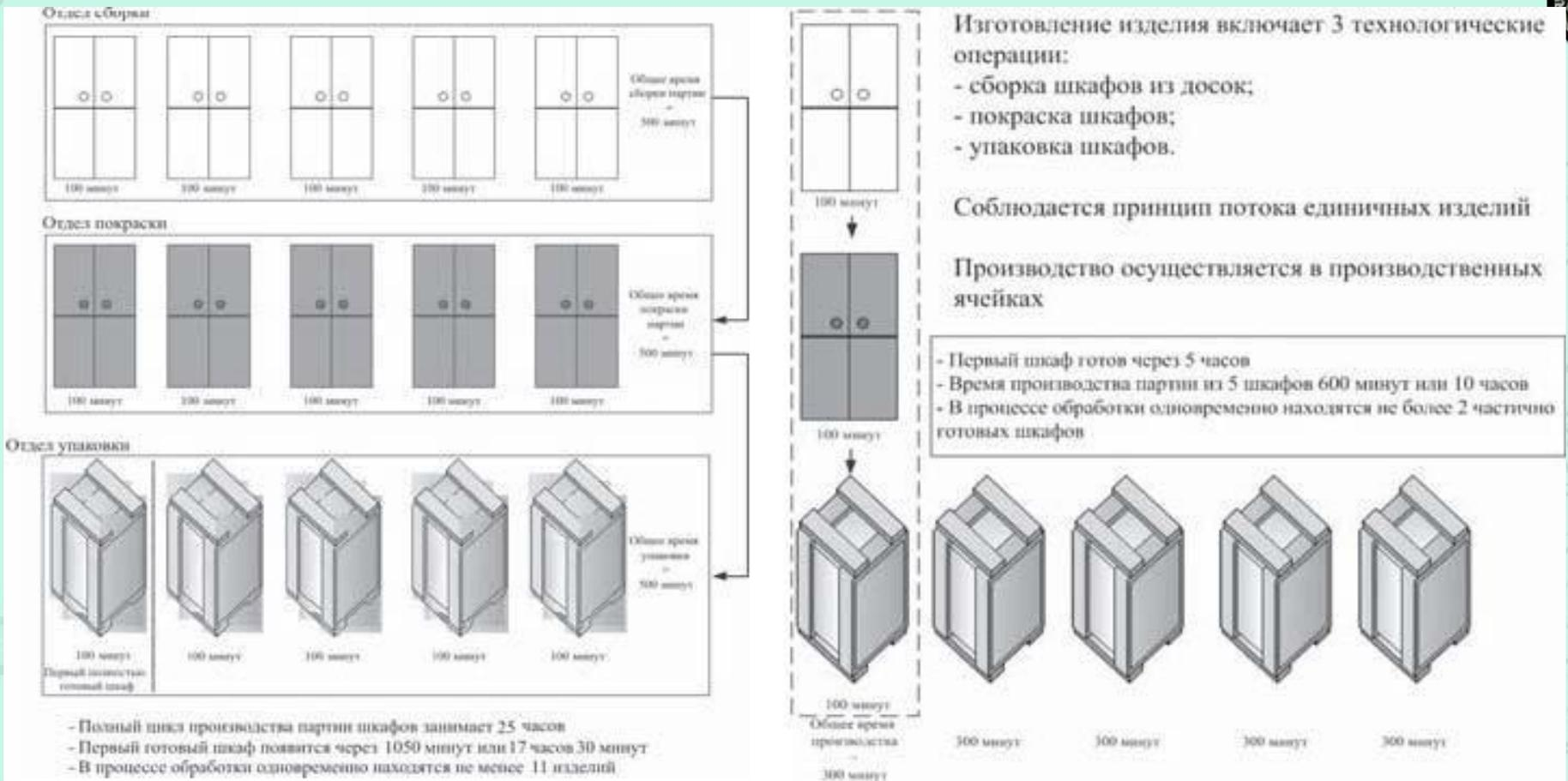
Процесс производства шкафов при толкающей системе производства
