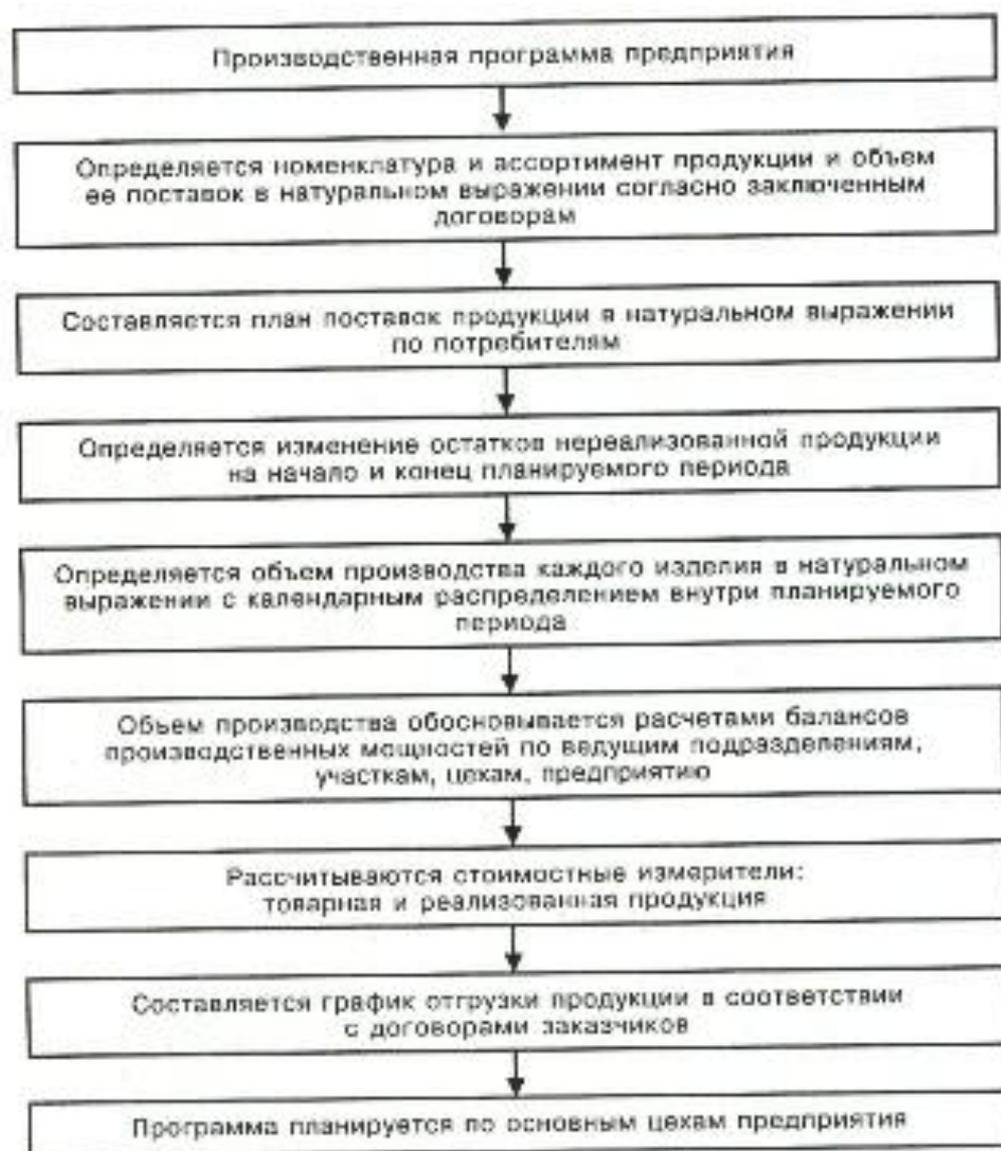
Рис. 9.7. Последовательность разработки производственной программы
