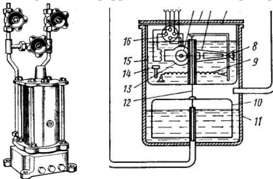
Рис. 109. Колокольный дифманометр (расходомер) типа ДКО: *a* — общий вид, *б* — схема: *1, 2, 3* — вентили, *4* — шестерня, *5* — рычаг, *6* — сектор, *7* — крышка, *8* — ось, *9* — пружина, *10* — колокол, *11* — корпус, *12* — подвеска, *13* — рамка, *14* — корректор, *15* — бачок с маслом, *16* — блок зажимов
