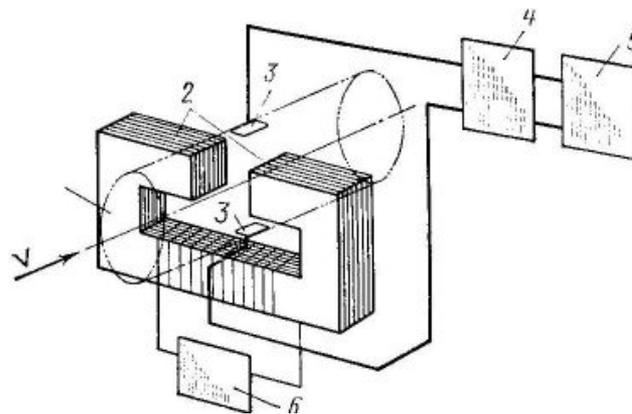
Схема индукционного расходомера
