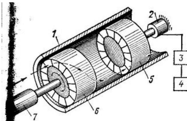
Схема массового турбо-расходомера:
