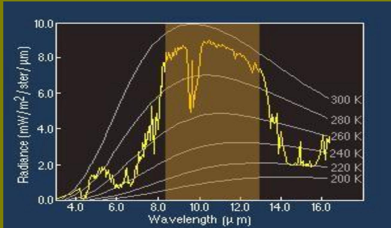
**Рис. 1.** Тепловое излучение поверхности Земли и атмосферное поглощение в ИК - диапазоне.
