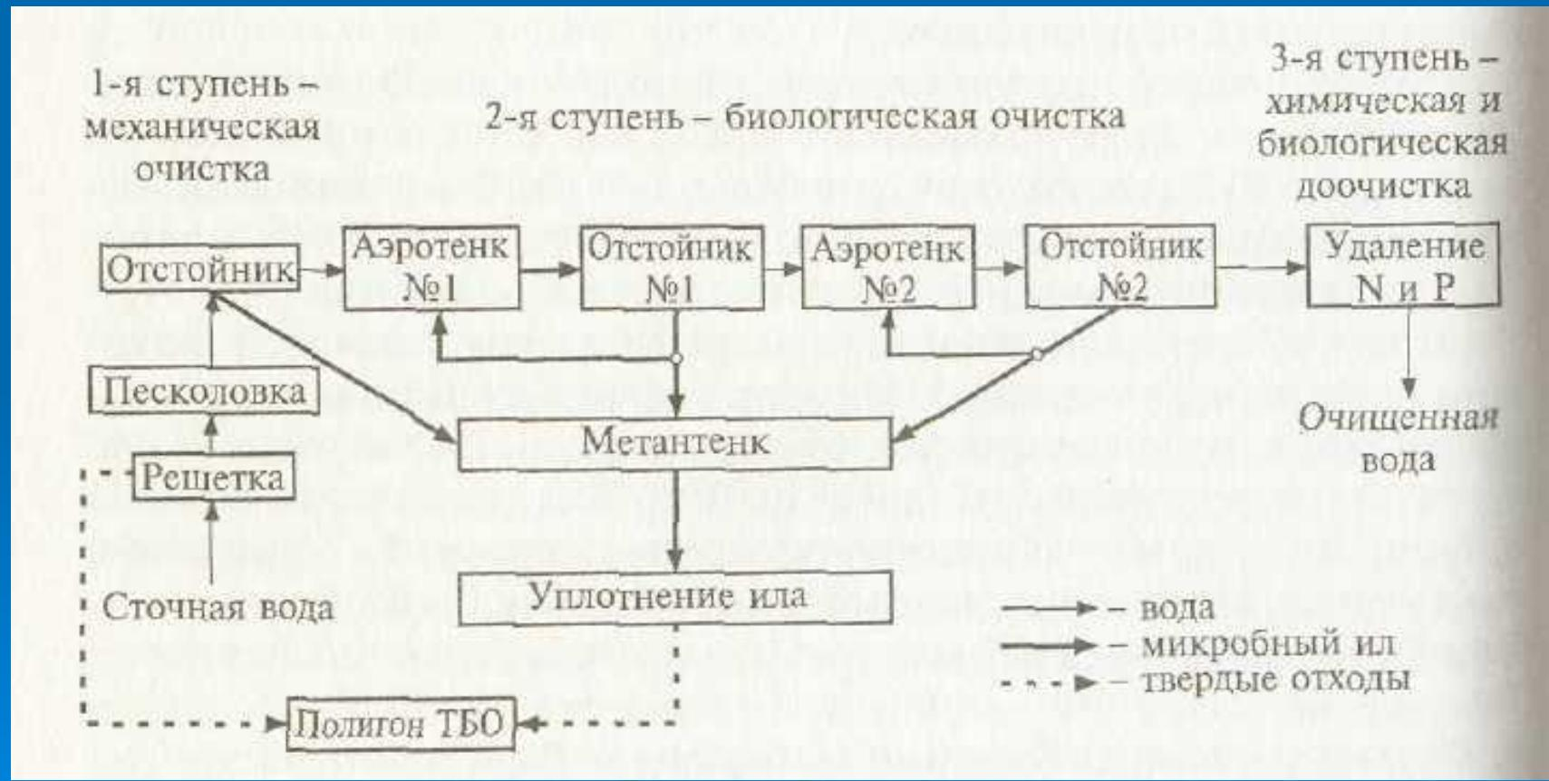
Обработанная в аэротенке вода и активный ил, состоящий в основном из микробной биомассы, разделяются в отстойнике (вторичный отстойник), из которого вода направляется для сброса в принимающий водоем или на **доочистку** (удаление азота и фосфора). Обычно на крупных станциях очистки сточных вод применяется система из двух последовательных аэротенков с отстойниками
