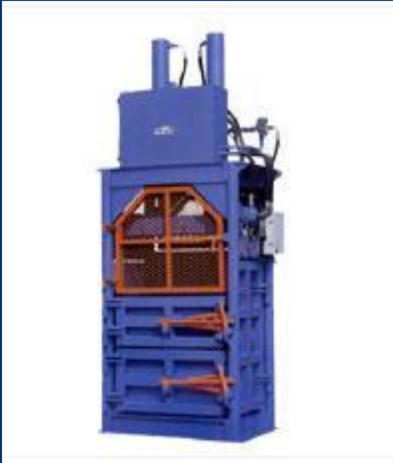
предназначен для упаковки различных твердых отходов, мусора типа макулатуры, полимерной пленки, пластмассовых ящиков, ПЭТ бутылок в кипы для дальнейшего складирования и/или переработки.
