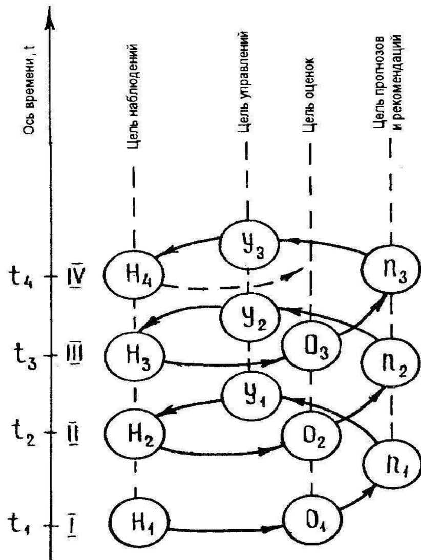
Схема функционирования эколого-геологического мониторинга во времени:  $H_i$  — наблюдения;  $O_i$  — оценка наблюдений;  $P_i$  — прогноз и рекомендации;  $U_i$  — управляющие решения; римские цифры — номера циклов
