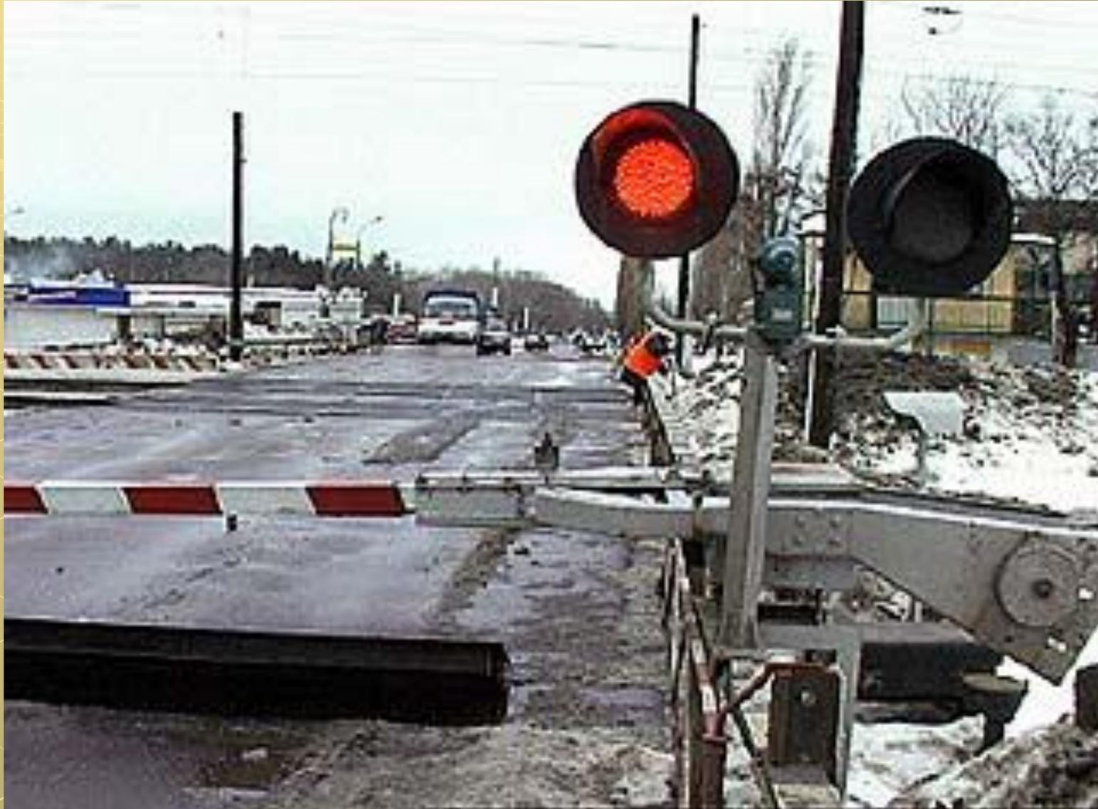
**Шлагбаум** (нем.(нем.упавшее дерево) — устройство для быстрого преграждения и освобождения пути в виде поворачивающейся вокруг горизонтальной или вертикальной оси стрелы.
