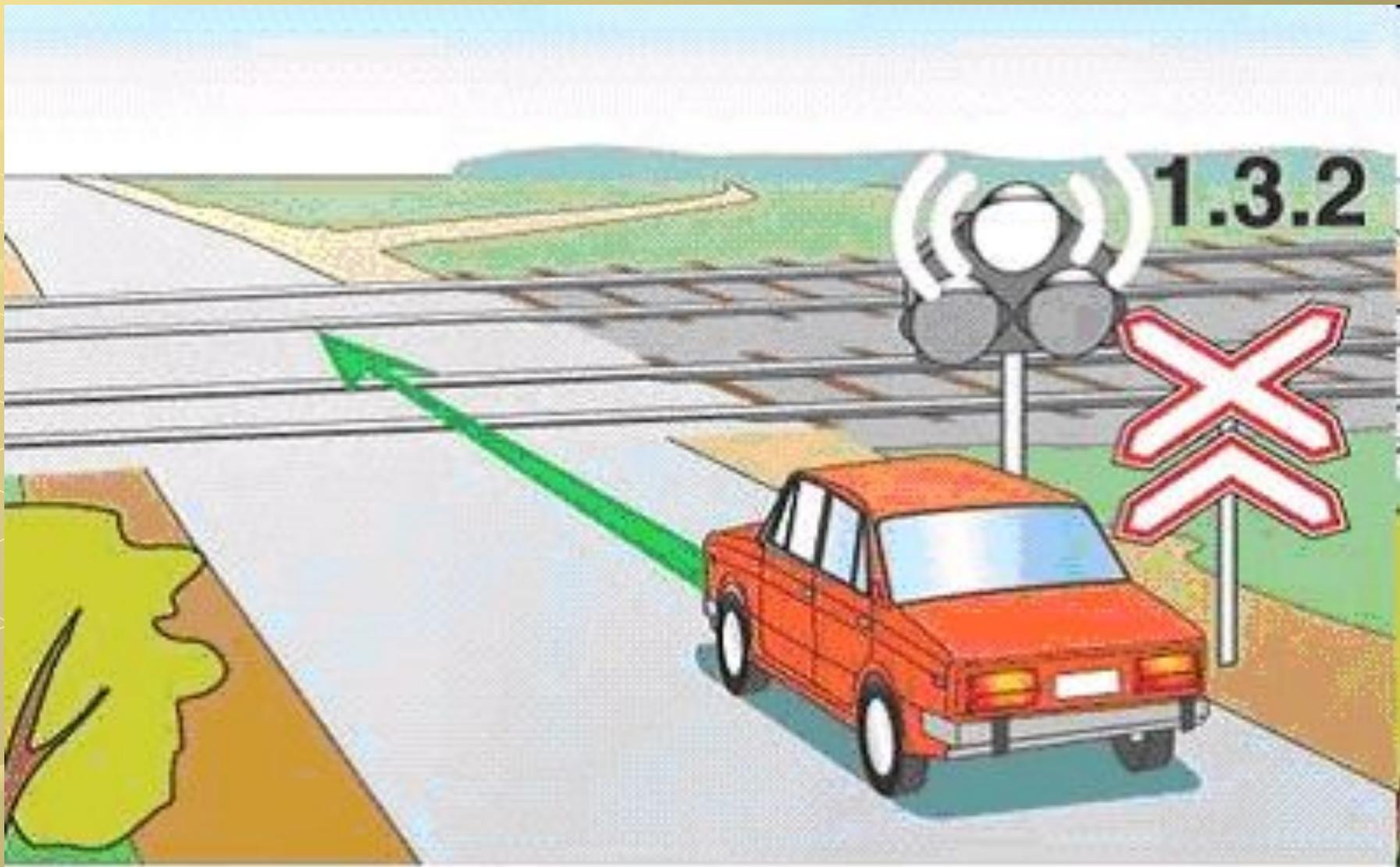
Два **попеременно мигающих красных фонаря** обозначают, что движение через переезд **запрещено**; данный сигнал обычно сопровождается **звуковой сигнализацией** (звонком).
