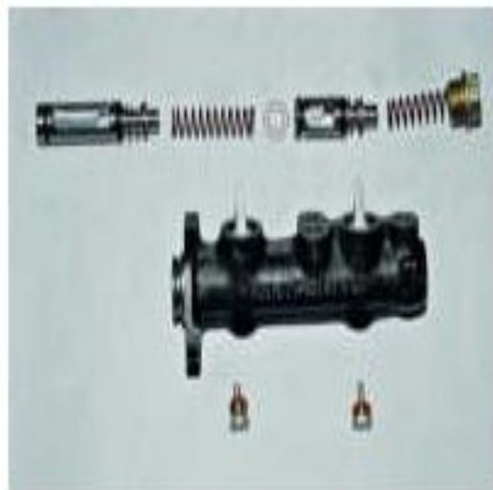
Ключом «на 12» отворачиваем два стопорных болта снизу цилиндра и извлекаем из него все детали. Укладываем их по порядку.
