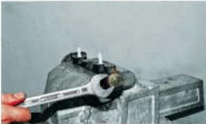
Ключом «на 22» отворачиваем торцевую заглушку.
