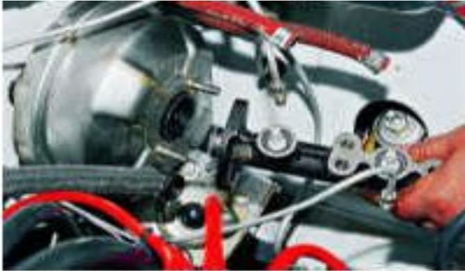
Снимаем главный тормозной цилиндр.
