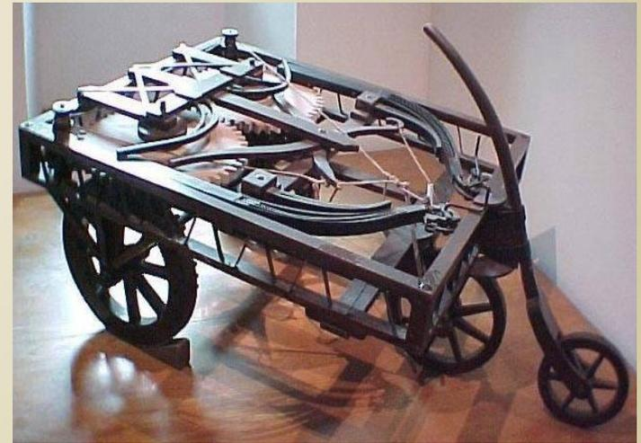
По принципу действия механизм напоминает детскую заводную игрушку. После того как взведена пружина, трехколесная деревянная тележка может проехать самостоятельно около 40 метров. Кроме того, она снабжена тормозом, который оператор дергает при помощи потайной веревки.
