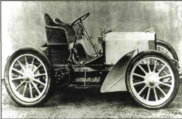
Первый «Мерседес» (декабрь 1900 г.) – прообраз современного автомобиля с простейшим кузовом для участия в автомобильных гонках. Для прогулок вместо такого кузова могли устанавливать другой кузов — четырехместный.
