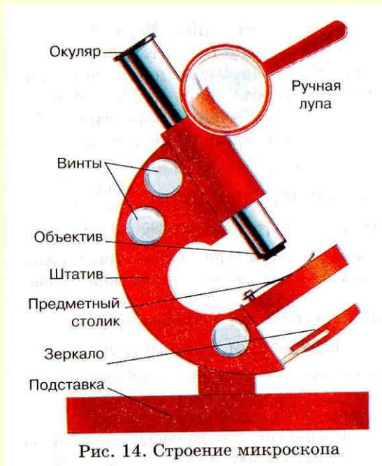
Рис. 14. Строение микроскопа
