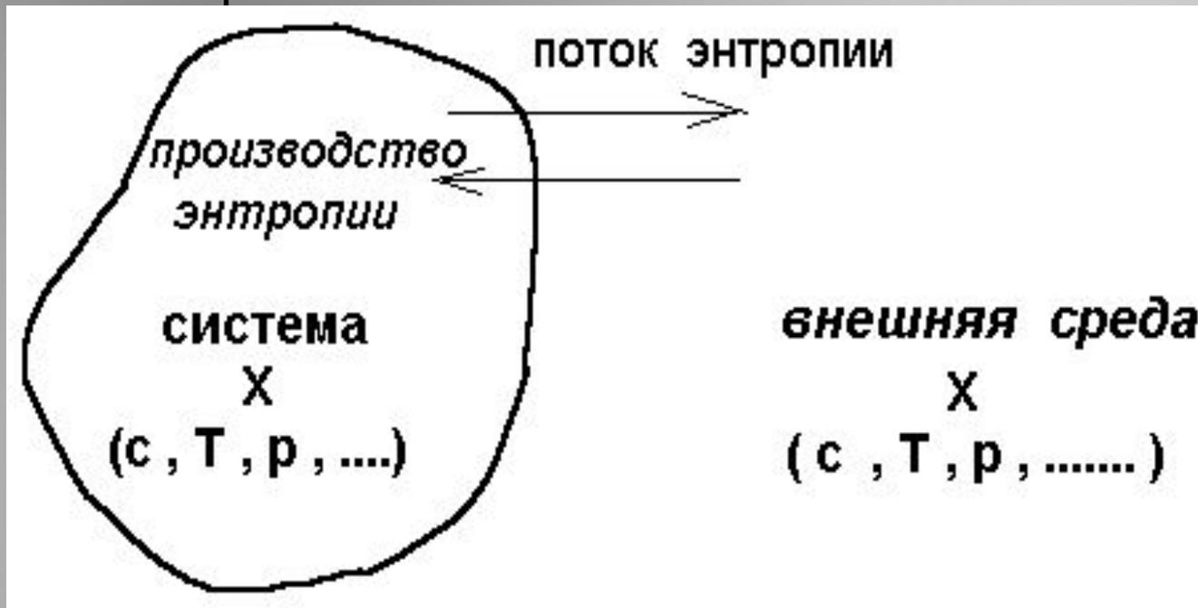
Рис. Схематическое представление открытых систем : производство и поток энтропии.
