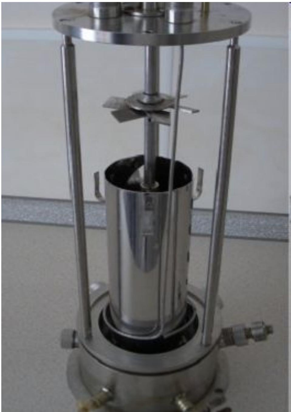
**Комплекс ферментационный КФ-108 с функцией работы в непрерывном режиме (хемостат, рН-ауксостат, турбидостат и др.)**
