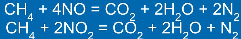
В качестве катализаторов используют различные металлы, которыми покрывают огнеупорные материалы – носители. Чаще применяют палладиевый катализатор, нанесенный на оксид алюминия. Температура начала контактирования при восстановлении – 400 – 470 °С.
