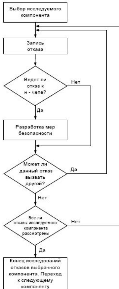
Рис.5.4. Алгоритм исследования отказов
