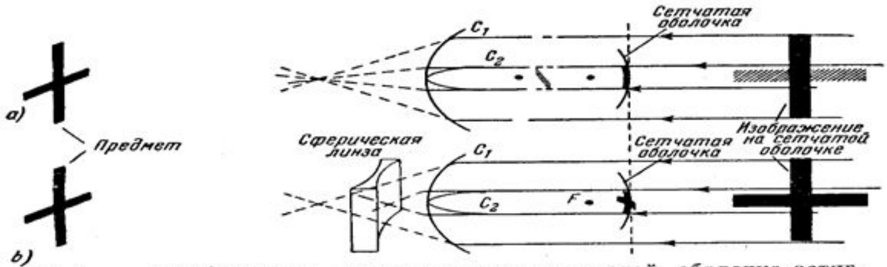
Рис. 8. Изображение, получающееся на сетчатой оболочке астигматического глаза (а). Кривизна  $C_1$  хрусталика глаза в вертикальном направлении отличается от кривизны  $C_2$  в горизонтальном направлении. Этот недостаток исправляется рассеивающей цилиндрической линзой (b).
