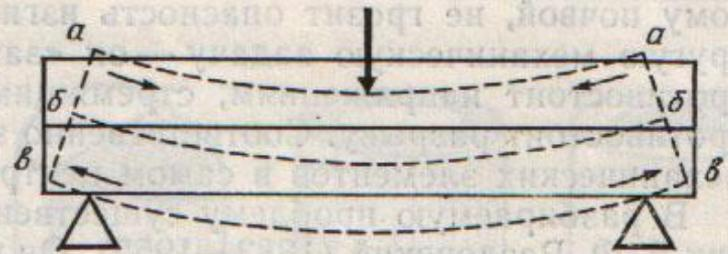
Рис. 74. Напряжения, возникающие в стержне при его прогибе.
