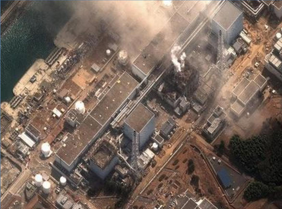
**В результате прихода мощной цунами были полностью выведены из строя системы охлаждения трех ядерных реакторов. Реакторы были заглушены, но без охлаждения стали перегреваться**
